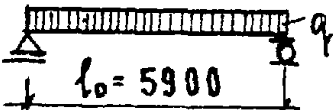
СХЕМА ОПИРАНИЯ И ЗАГРУЖЕНИЯ ПРИ ИСПЫТАНИИ (ПЛОЩАДЬ ЗАГРУЖ. 5,9×1,46 м)
